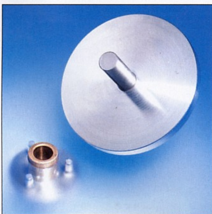
Bewährt gut: Die Lagerbüchse des Emotion besteht aus Sinterbronze, der in den Alu-Innenteller eingepresste Schaft besteht aus poliertem Edelstahl.
