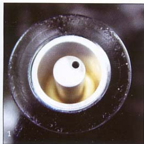
1: het inverterende lager met de lageras en het oliebad 2: motorbehuizing met pulley en snaar
