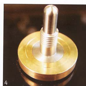
4: spindel met schroefdraad en rand waar tussen het plateau wordt vastgeklemd
