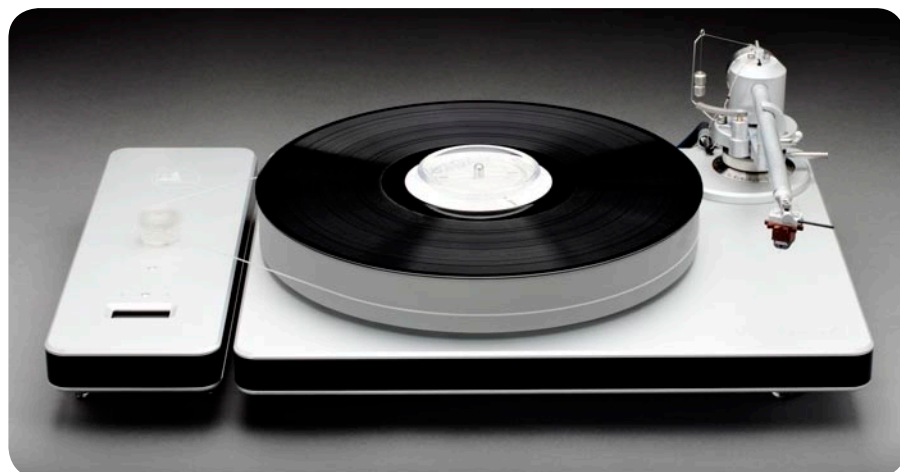
Der Clearaudio Ambient besteht aus zwei Teilen. Der Motorblock ist dabei physisch vom eigentlichen Laufwerk getrennt, um Vibrationen vom Plattenteller fernzuhalten
