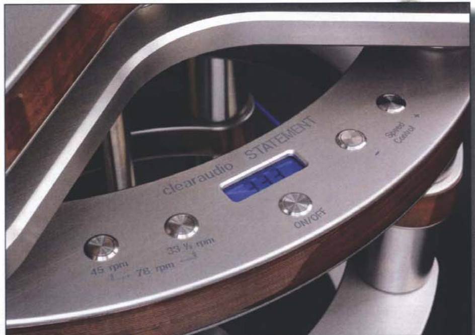
Das Display zeigt die tatsächlich gemessene Drehzahl an. Für deren Unerschütterlichkeit sorgt ein geregelter Gleichstrommotor
