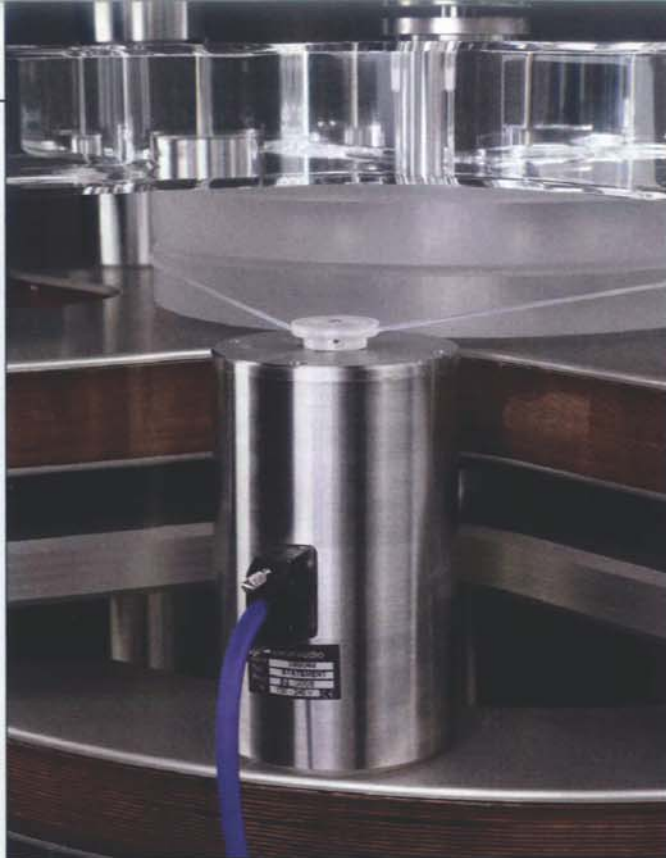
Von dem massiven Gleichstrommotor ist normalerweise kaum etwas zu sehen, der dicke Zylinder werkelt hinter dem Laufwerk verborgen
