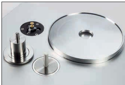
Auf der extrem reibarmen, geölten Keramikachse (M.) sitzt das magnetisch abgestoßene Mittelstück (I.), das den flachen Subteller trägt
