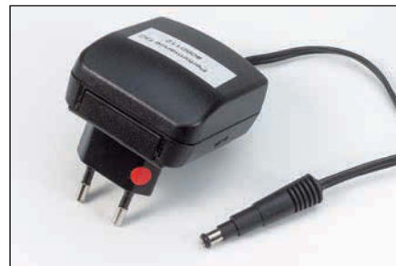
Bei falsch herum einstecktem Netzteil leidet die Klangqualität. An unserem Testmuster haben wir deshalb die Phasenseite markiert
