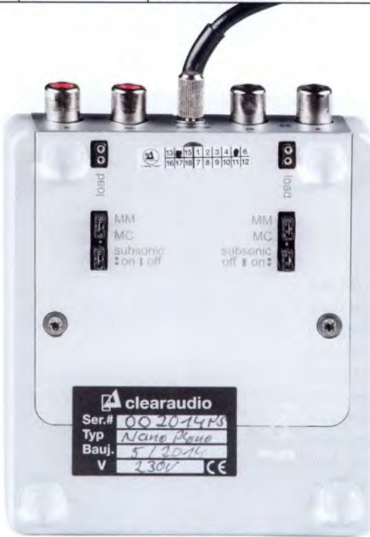
Die Phonovorstufe wird mit Steckbrücken an der Unterseite parametrisiert
