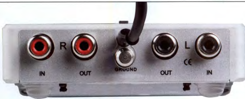
Eingang, Ausgang, Erdungsklemme und ein fest verbundenes Netzteilkabel: die Rückseite der Nano Phono V2
