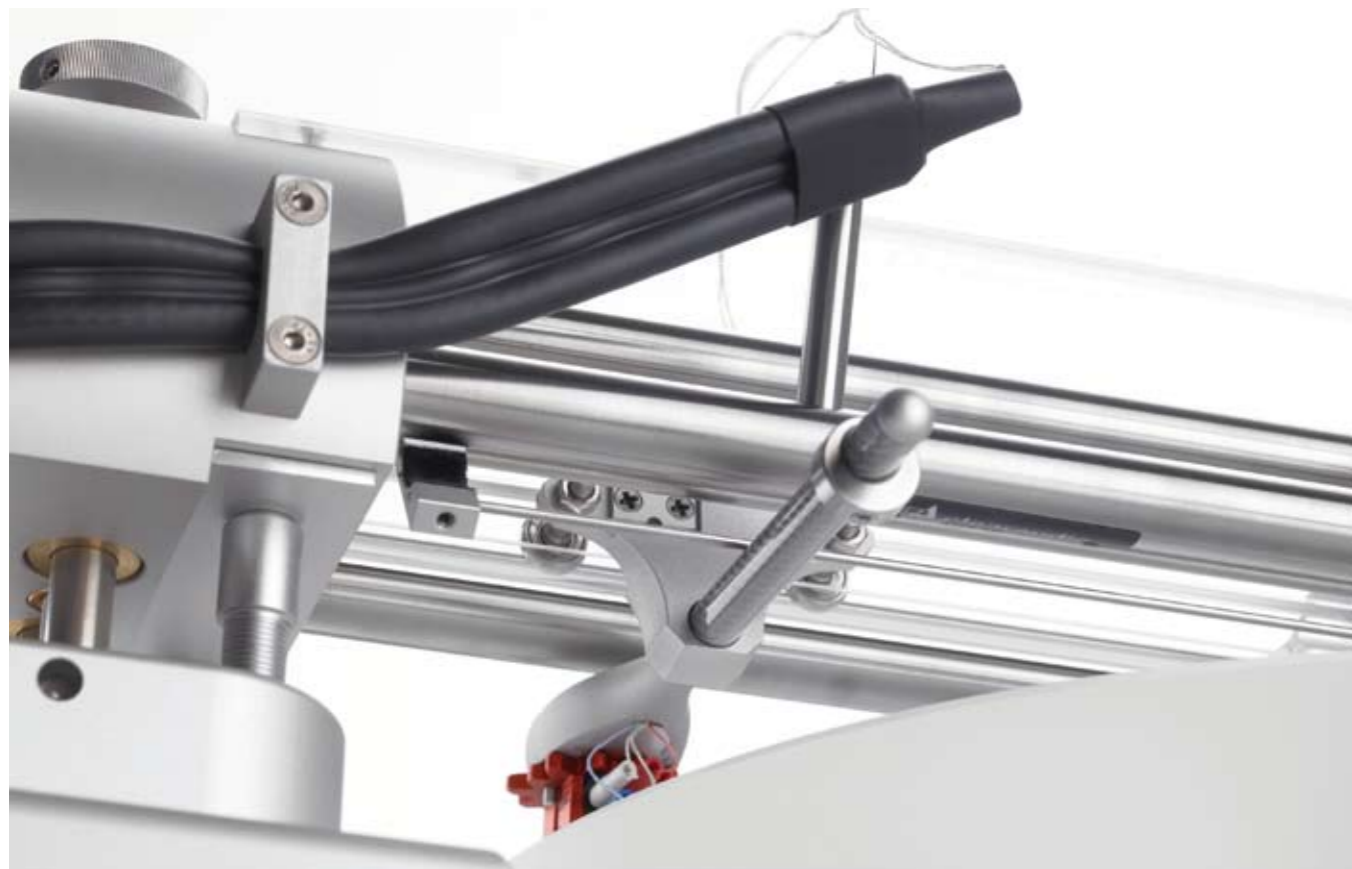
IMMER AUF LINIE: Der Tangentialarm TT-2 führt das System mit stets korrektem Spurwinkel parallel über die Platte und folgt damit exakt dem Weg des Schneidstichels. Der kleine Armstummel hängt dabei an einem auf Rollen gelagerten Schlitten, der in einem polierten Glasrohr weitestgehend staubgeschützt und sehr leichtgängig hin- und hergleiten kann. Zum Plattenwechsel klappt man die gesamte Traverse hoch.
