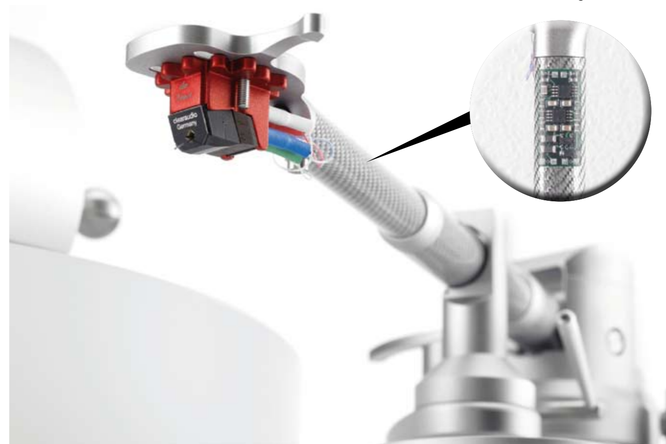
PERFEKTES PAAR: Das DaVinci ist Clearaudios drittbestes MC. Markentypisch besitzt es einen symmetrischen Generator mit vor und hinter dem Drehpunkt angeordneten Spulen, umgeben von insgesamt acht winzigen Einzelmagneten. Nach weniger Zentimetern Anschlussdraht erreichen seine Signale bereits den Vorverstärker (Ausschnitt) der sich im vorderen Ende des Armrohrs versteckt.
