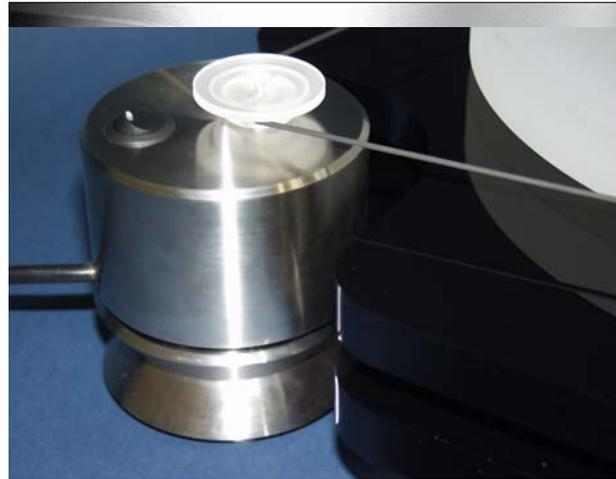
5. Der Befestigungsschraube des Tonarms wird vorsichtig in das Tonarmbasisoberteil geschraubt. Ziehen Sie anschließend die Tonarmbefestigungsmutter über das Tonarmkabel und schrauben Sie diese auf den Befestigungsschraube des Tonarmes.
