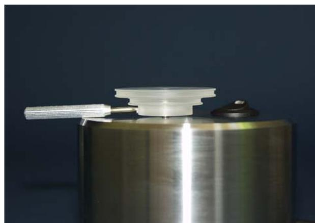
4. Stellen Sie nun die Motorantriebseinheit in die dafür vorgesehene Ausbuchtung der Plattenspielerbasen. Der Schalter muss nach außen zeigen und der Abstand zwischen Motorblock und Chassisplatte etwa einer Daumenbreite entsprechen. (genauere Justage siehe Kapitel 4. Drehzahleinstellung).
