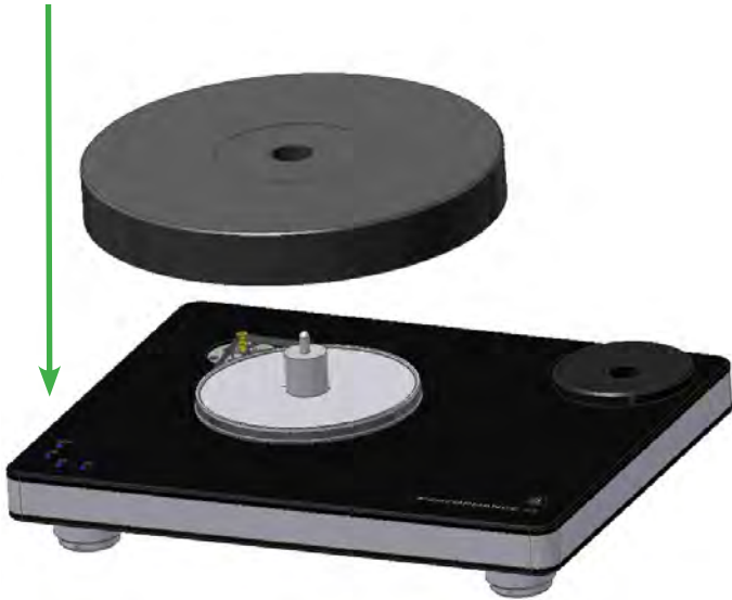
Abb. 8: Aufsetzen des Plattentellers auf das Lager
