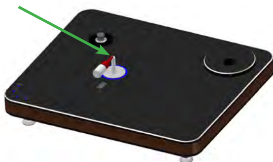
Abb. 5: Ölen der Keramikachse
