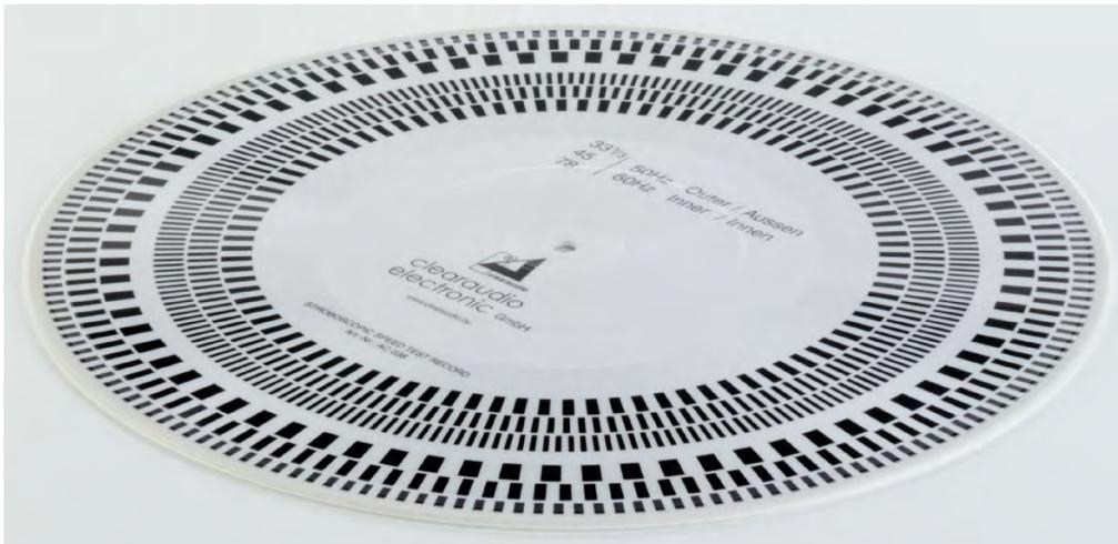
Le disque test *Stroboscope Testrecord* de **clearaudio** est conforme aux exigences les plus sévères relatives à un réglage précis de la vitesse sur les platines disques microsillon. Une augmentation spectaculaire de la qualité sonore peut être obtenue grâce à des vitesses dont la précision a été calibrée avec exactitude.
