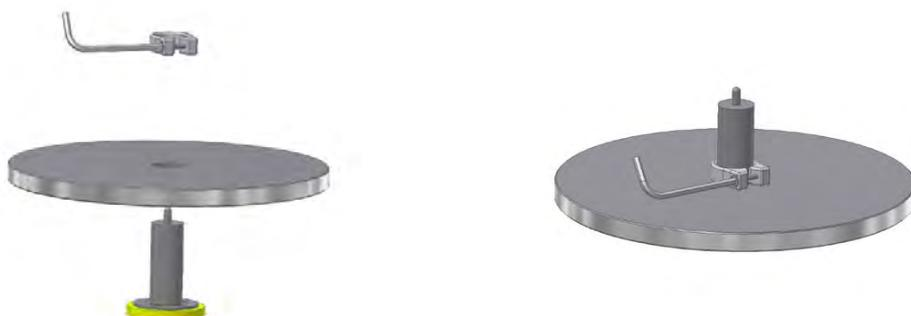
III. 7: Assemblage du plateau en acier sur le contre-axe.
