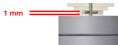
Abb. 12: Befestigen des Antriebsrades
