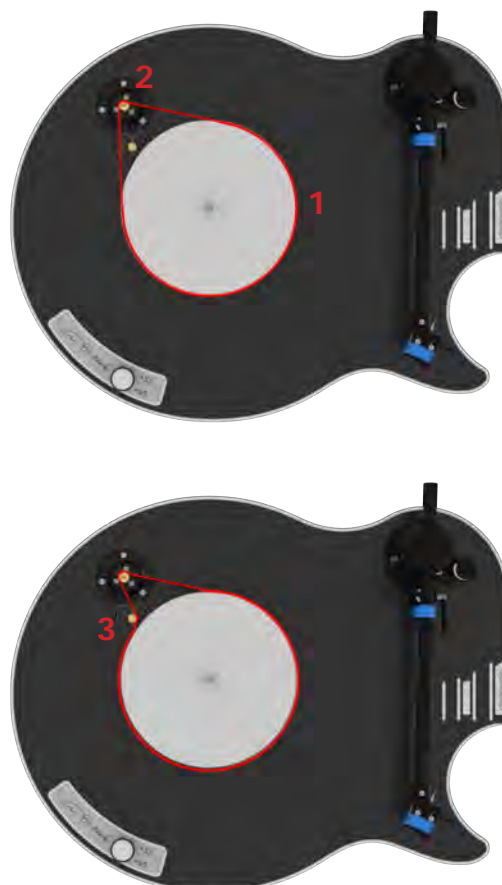
Abb. 4: Auflegen des Riemens
