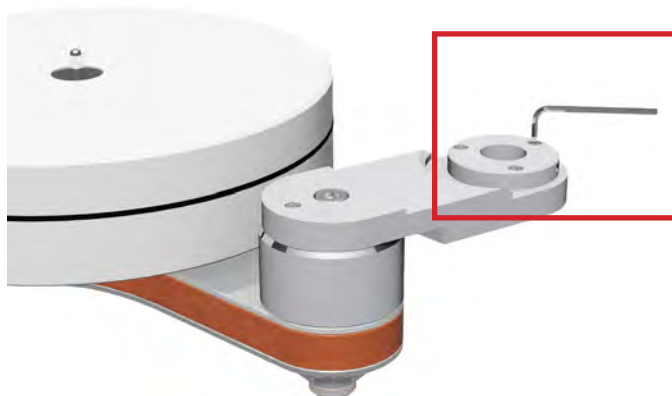
Abb. 6: Befestigen der Klemmbasis
