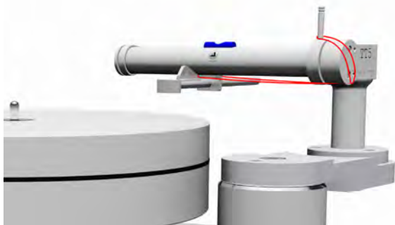
Abb. 8: Montage des Tonarmes
