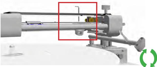
Abb. 15: Einsetzen des Headshells-Rohrs
