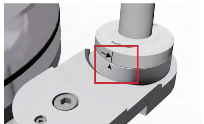
Abb. 15b: Montage der swing base (nach hinten)
