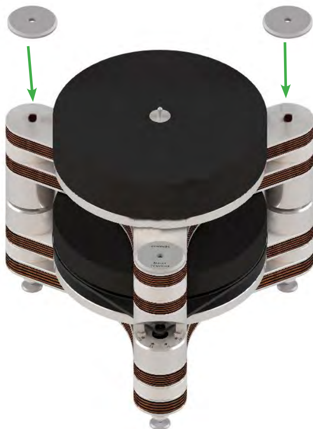
Abb. 5: Platzieren der Aluminium-Distanzscheiben auf dem Master Innovation Plattenspieler
