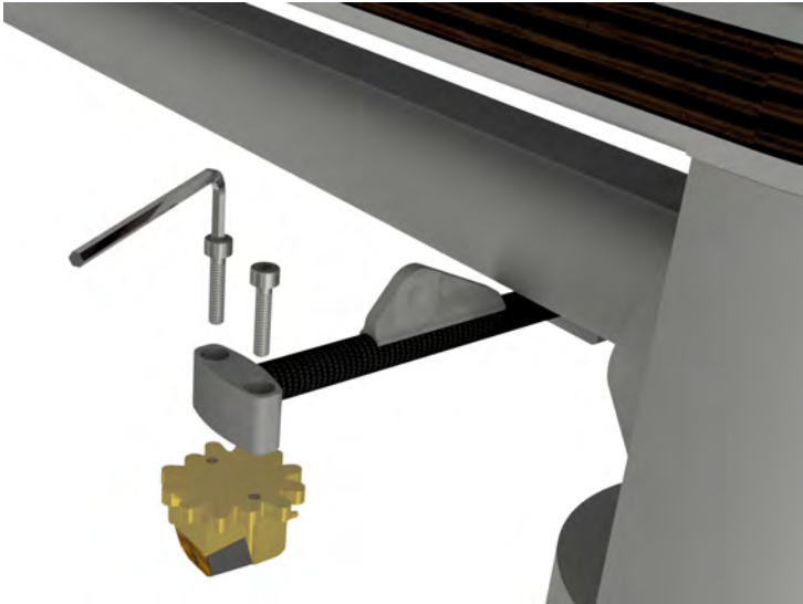
Abb. 15: Montage des Tonabnehmers
