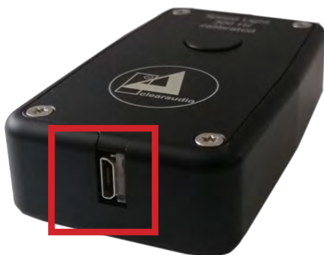
Abb. 1: Micro-USB für direkten Stromanschluss.
