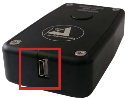
Abb. 1: Micro-USB für direkten Stromanschluss.
