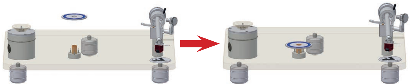
Abb. 8: Aufsetzen des Magnetrings auf die Achse Die mit Kleber beschichtete Seite des Magnetrings muss zur Laufwerksoberfläche weisen. Bitte pressen Sie den Magnetring über die Lagerbuchse zentriert auf das Laufwerkschassis an.
