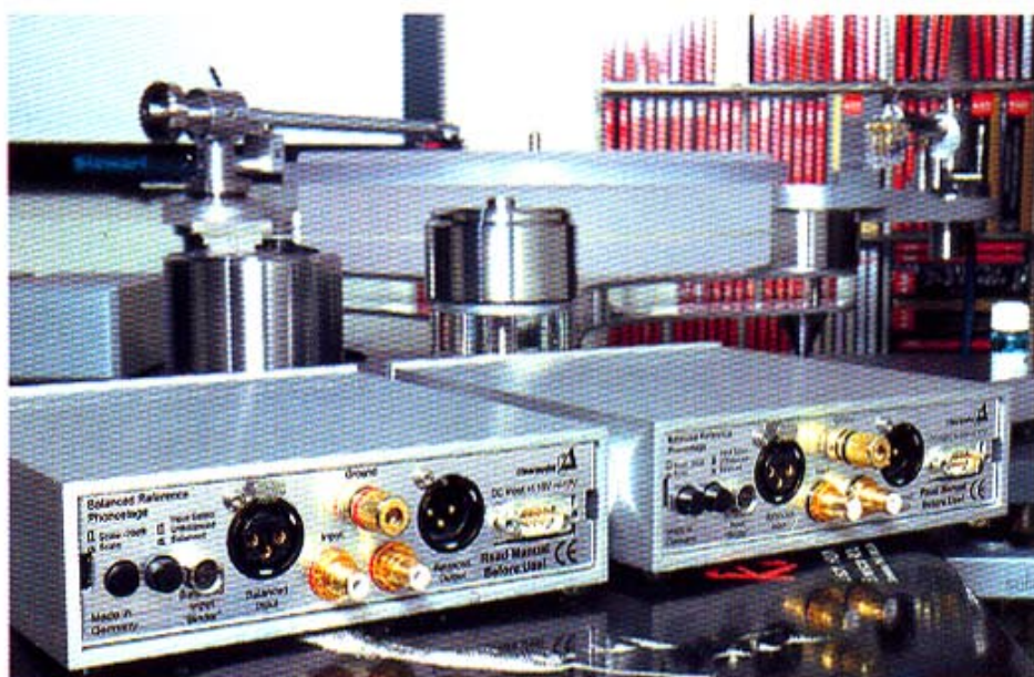
▲Clearaudio Balance Reference唱頭放大器設有平衡式輸入及輸出，試聽時用了單端式。
