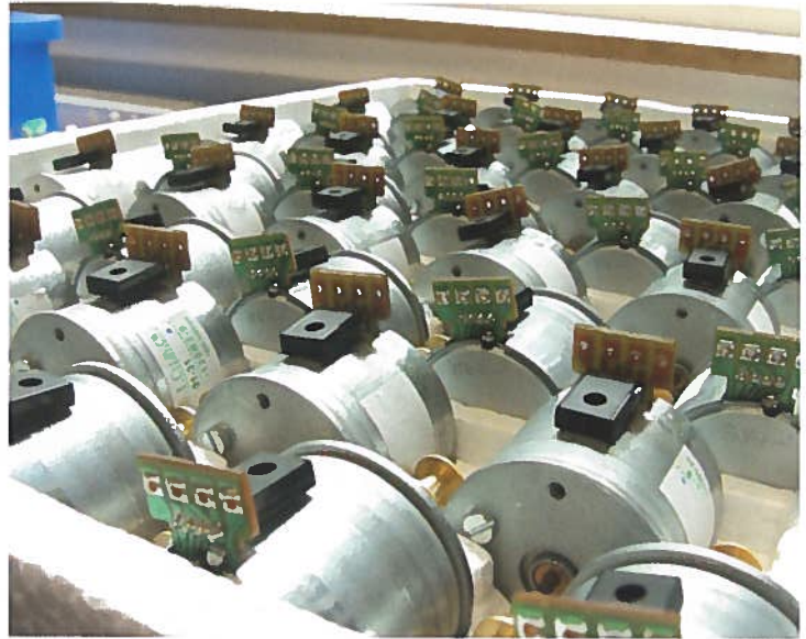
Eine Palette frisch angelieferter Motoren steht für den Einbau in die Plattenspieler des Hauses bereit.
