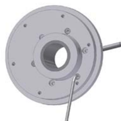
Abb. 8: Befestigung des VTA-Lifters auf der Champion Basis
