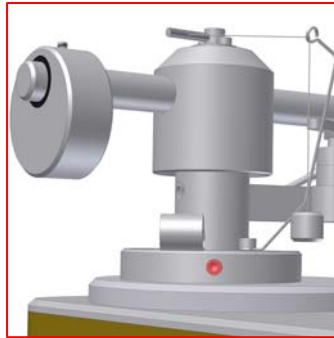
illustration 9: seconde vis pour le réglage de la hauteur
