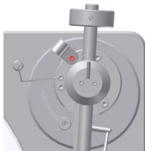
Bild 3: Befestigung der Kabelführung an der Tonarmbasis
