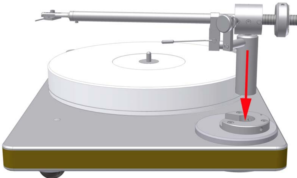
illustration 2: montage du bras de lecture sur l'embase
