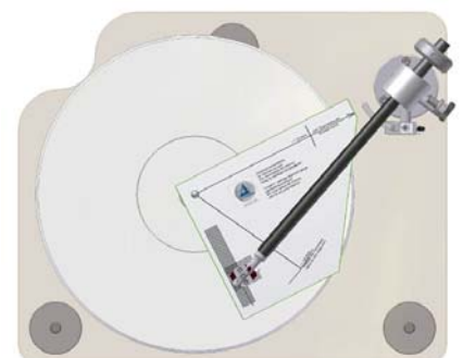
Abb.9: Absenken des Tonabnehmers auf der Schablone
