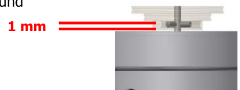
Abb. 13: Befestigen des Antriebsrads
